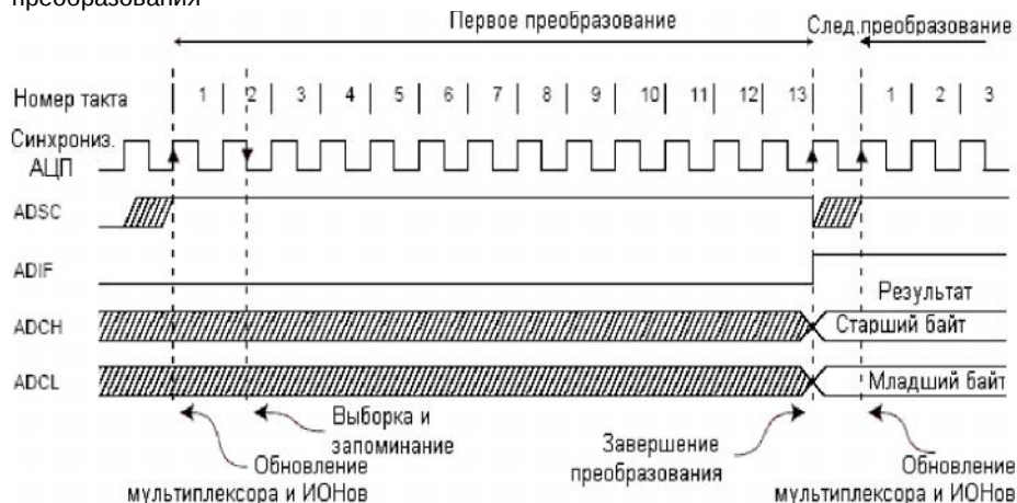
Рисунок 93. Временная диаграмма работы АЦП в режиме одиночного преобразования
