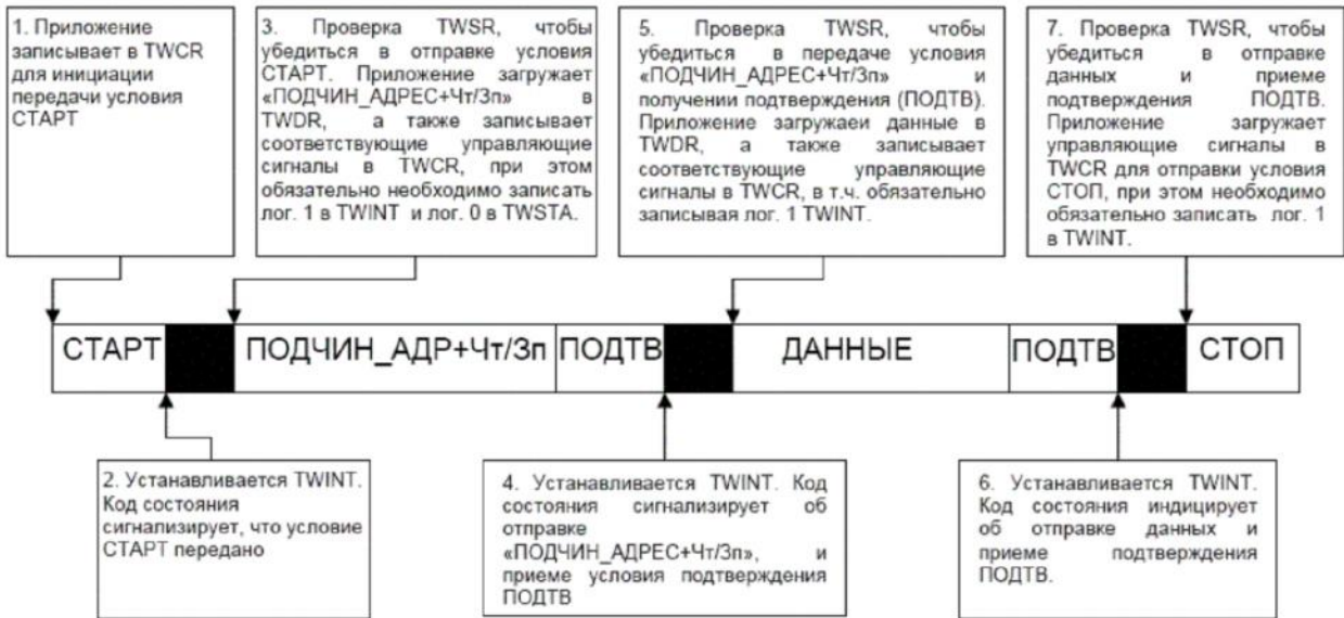
Рисунок 77. Последовательность обслуживания TWI при типичной передаче
